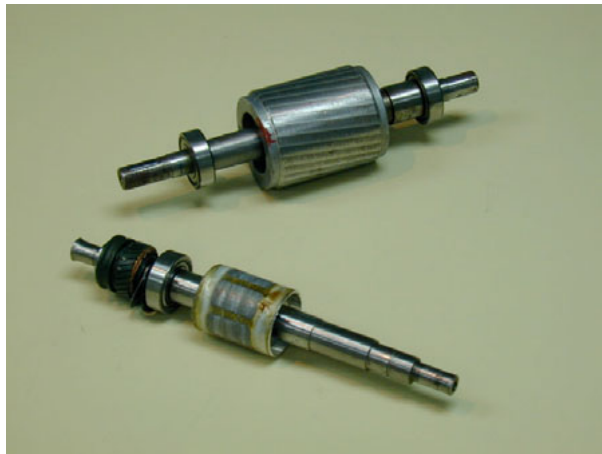
Comparativa entre rotor de motor asíncrono y de servomotor
