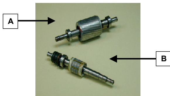
Diferencias entre rotor en jaula de ardilla (A) y de imán permanente (B)
